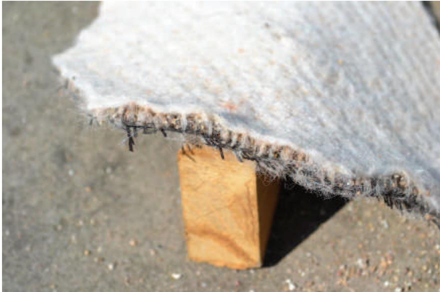
Abb. 4-3 Bentonitabdichtung
