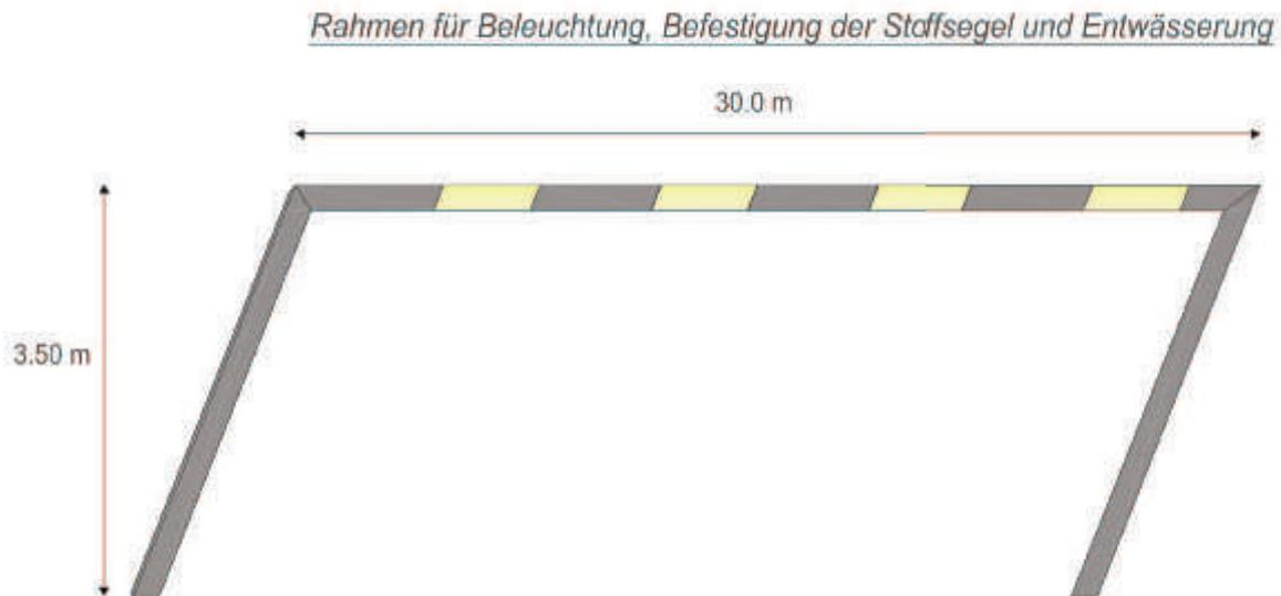
Der verschobene Rechteck-Stahlrahmen ist ein V-Profil. Neben der guten Stabilität dient dieses Profil auch gleichzeitig als Entwässerungsrinne für die Leinensegel. Die fünf Segmente der gesamten Konstruktion werden in der sich im Stahlrahmen befindlichen Leiste eingehängt und sind somit sicher verankert. Im Rahmen eingebaute LED sorgen für eine ausreichende und energieschonende Beleuchtung des Ortsplatzes.
