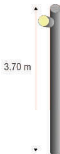
Die 3.70 Meter hohen Stahlpfosten dienen sowohl zur Beleuchtung als auch zur Befestigung der Stoffsegmente. Am oberen Rand der Pfosten befinden sich leuchtstarke LED Lampen, die die hellen acrylbeschichteten Segel von unten beleuchten. Ebenfalls am oberen Rand befinden sich Ösen in denen die Segel eingehängt werden. Da der Pfosten um 20 cm höher als der Stahlrahmen ist, liegt das Acrylsegel in ausreichendem Gefälle und sorgt gleichzeitig für die Entwässerung.
