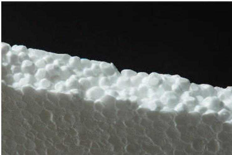
Abb. 3-9 Polystyrolpartikelschaum (EPS)
